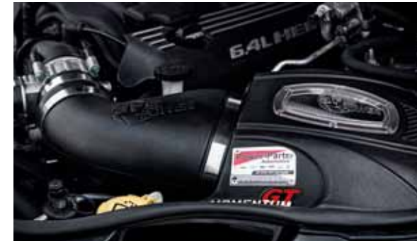
Für üppige 35 PS Mehrleistung sorgt das "Momentum GT"-Ansaugsystem, das per Einzelabnahme vom TÜV eingetragen wird.
