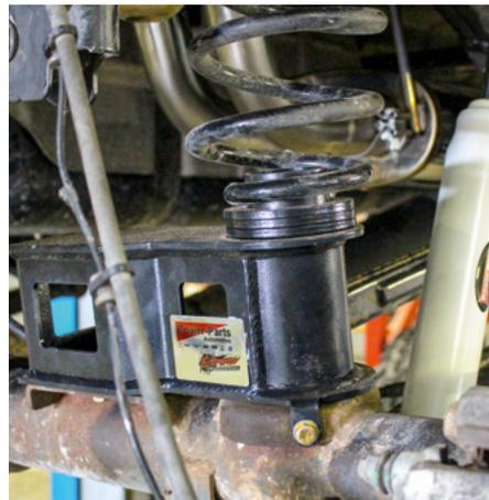
Massiv: Die Federn und Dämpfer an der Hinterachse wurden ausgetauscht. Ein Distanzstück bringt zusätzliche Höhe.
