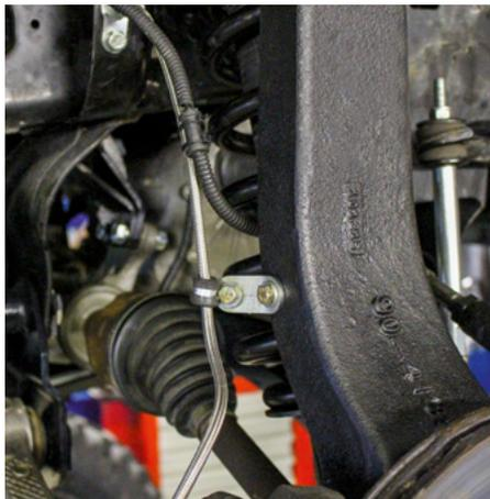
Verlängert: Die Bremsleitungen mussten bei 32 Zentimetern mehr Höhe angepasst werden. Jetzt bestehen sie aus Edelstahl.
