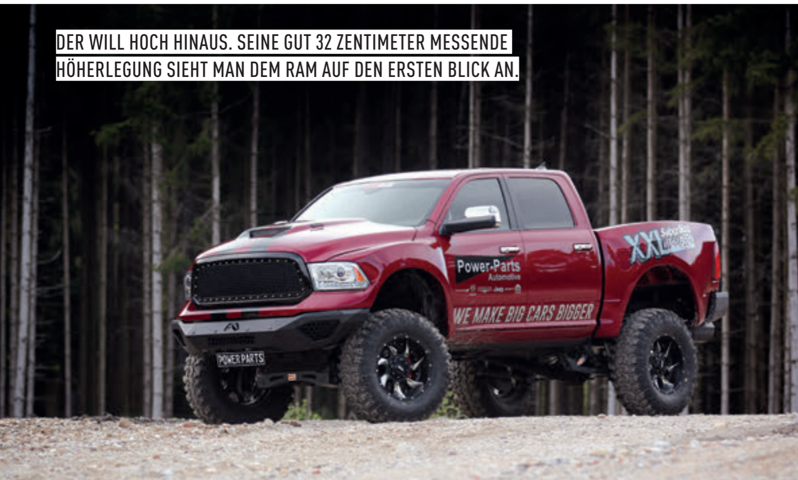
OFFROAD-WHEELS IN KREISSÄGEN-OPTIK: MATTSCHWARZE GRID G01 IN 10X20 ZOLL MIT SUPERSWAMPER M/T-BEREIFUNG IN 39,5X13,5R20
