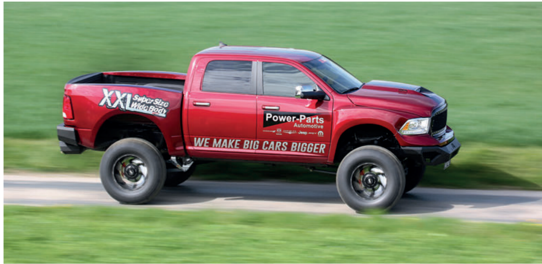
OFFROAD-WHEELS IN KREISSÄGEN-OPTIK: MATTSCHWARZE GRID G01 IN 10X20 ZOLL MIT SUPERSWAMPER M/T-BEREIFUNG IN 39,5X13,5R20
